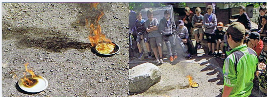
Das Experiment mit dem Gerätebenzin und herkömmlichem Benzin wurde im Freien durchgeführt. Links, der Teller mit dem Gerätebenzin, welches viel weniger Rauch entwickelte und dessen Tellerrand auch sauberer blieb, als der Teller mit dem herkömmlichen Benzin.
